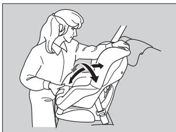
5. Spingere la linguetta verso il basso. Disporre la parte superiore della cintura nella fessura sul lato del seggiolino.
