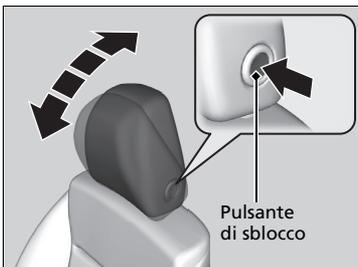
**Per inclinare il poggiatesta in avanti:** Spingere la parte posteriore in avanti.
