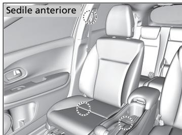
Durante la sostituzione delle cinture di sicurezza, utilizzare i punti di ancoraggio mostrati nelle immagini.
