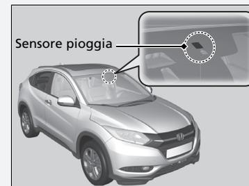
Non portare la leva tergicristalli su **AUTO** quando si pulisce il parabrezza o durante gli spostamenti all'interno di un autolavaggio. Se la leva tergicristalli si trova su **AUTO**, e il commutatore di accensione è su ACCENSIONE **II**<sup>\*1</sup>, il sensore pioggia potrebbe rispondere al movimento delle mani o ai liquidi di lavaggio e i tergicristalli potrebbero azionarsi automaticamente.
