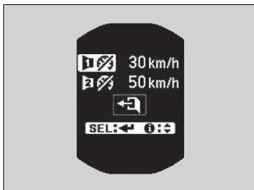
1. Premere il pulsante ▲①/▼ fino a quando la schermata di impostazione dell'allarme velocità non viene visualizzata sul display, quindi premere il pulsante **SEL/RESET**.
