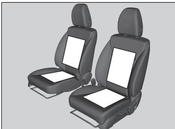
Per poter utilizzare i riscaldatori sedili, il commutatore di accensione deve trovarsi su ACCENSIONE **II**\*1. Con i riscaldatori impostati su ALTO i sedili si riscaldano più rapidamente rispetto all'impostazione BASSO.
