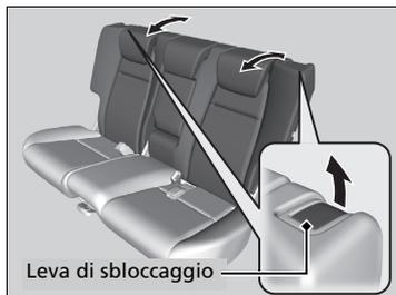
Tirare la leva sul lato destro per cambiare l'inclinazione della parte destra dello schienale e sul lato sinistro per la parte sinistra.
