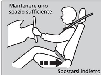
Regolare il sedile del conducente in una posizione il più lontano possibile che consenta tuttavia di mantenere il controllo completo del veicolo. Tale posizione deve consentire al conducente di sedersi in posizione eretta, rimanere ben appoggiato al sedile, premere i pedali senza doversi inclinare in avanti e afferrare il volante agevolmente. Il sedile del passeggero anteriore deve essere regolato in modo simile, in una posizione il più lontano possibile dall'airbag anteriore nella plancia.
