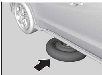
**6.** Posizionare il pneumatico di scorta (lato esterno della ruota verso l'alto) sotto alla carrozzeria del veicolo, vicino allo pneumatico da sostituire.
