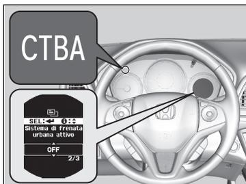
È possibile attivare e disattivare il sistema usando il display multi-informazioni.
