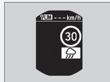
■ **Quando il sistema di riconoscimento della segnaletica stradale rileva il limite di velocità mentre il limitatore di velocità intelligente è in pausa**
