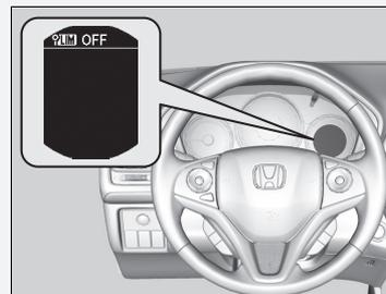
Se si rileva un problema nel sistema o nel sistema di riconoscimento della segnaletica stradale quando si utilizza il limitatore di velocità intelligente, viene emesso un segnale acustico e si accende la spia **OFF**. Il limitatore di velocità intelligente viene disattivato.
