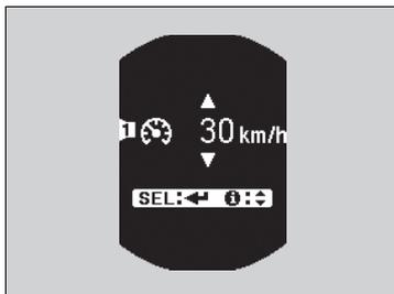
1. Premere il pulsante ▲/▼ fino a quando il menu di impostazione dell'allarme velocità non viene visualizzato sul display, quindi premere il pulsante **SEL/RESET**.
