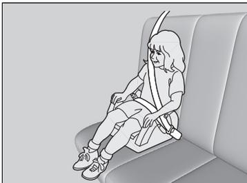
Se la cintura di sicurezza a tre punti di ancoraggio non può essere usata correttamente, far sedere il bambino su un cuscino di rialzo sul sedile posteriore. Per la sicurezza del bambino, controllare che l'età e il peso del bambino corrispondano alle raccomandazioni del produttore del cuscino di rialzo.
