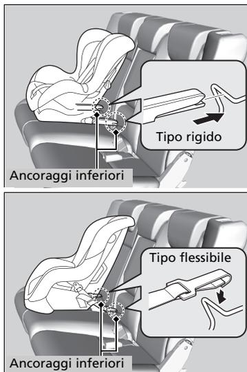
4. Posizionare il seggiolino sul sedile del veicolo, quindi fissarlo agli ancoraggi inferiori come riportato nelle istruzioni fornite con il seggiolino stesso.
