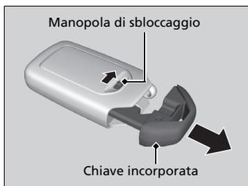
La chiave incorporata può essere utilizzata per bloccare le portiere quando la batteria del comando a distanza è scarica e la chiusura/apertura centralizzata è disabilitata.
